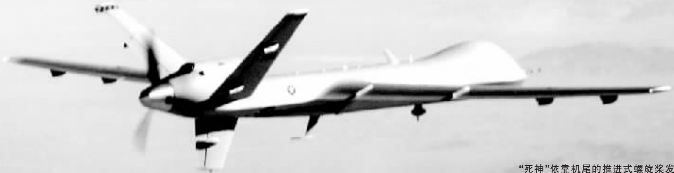
“死神”依靠机尾的推进式螺旋桨发动机提供动力
