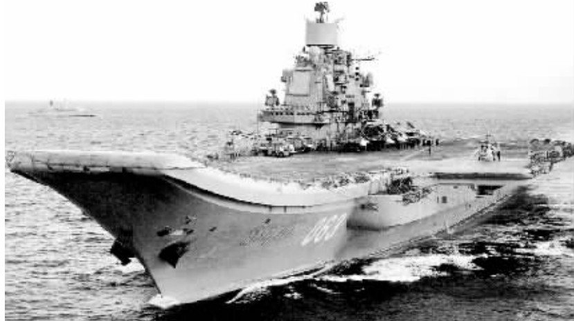
“库兹涅佐夫元帅”号航母目前隶属俄罗斯北方舰队,排水量5.5万吨,长302米,最高航速30节,额定船员1960人,可搭载36架飞机和16架直升机,于1993年起被编入战斗序列。
