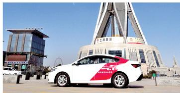
没有任何拖沓。据了解,MG GT搭载的SGE 1.4TGI缸内中央直喷涡轮增压发动机,最大功率可达110千瓦,匹配TST 7速双离合变速器,换挡迅捷、平顺,换挡时间不到0.2秒,而零到百公里加速时间仅为9.5秒,综合油耗为百公里5.9升。
