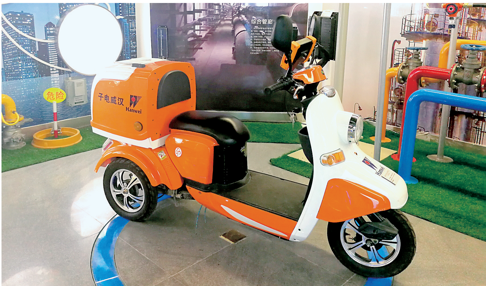
这辆小电动车一走过就知道附近有没有燃气管道漏气。郑报融媒记者 李丽君 图
