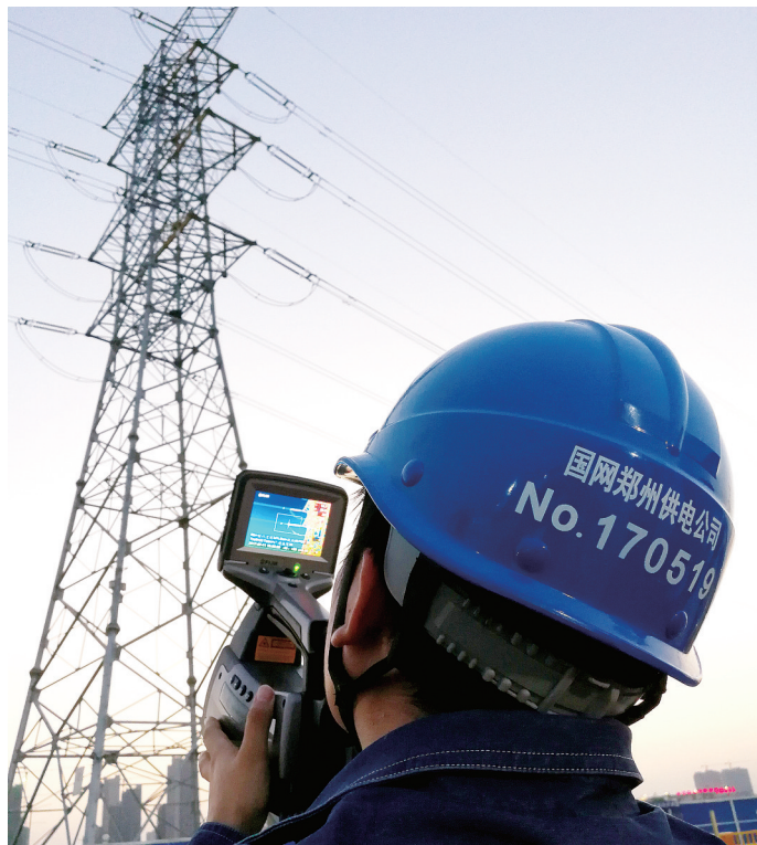
工作人员手持仪器对着杆塔上的线网进行远程测试
