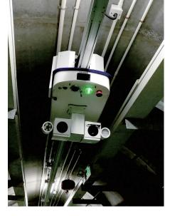
本报讯 人工巡检4公里电缆隧道,背着各种仪器的巡检人员要走1个小时。现在,小小的机器人倒挂金钟,在电缆隧道内边查边看边上传数据,半个小时就完成了。昨日,南三环电缆隧道内,记者和省内首个智能机器人一起巡检,体验科技带来的变化。
