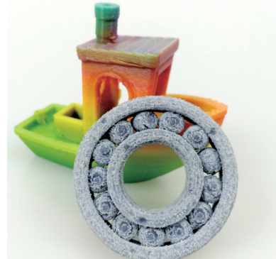
彩色3D打印的小船和粉末烧结打印出的轴承
