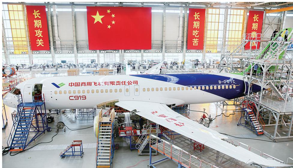
10月18日,记者来到中国商飞公司上海飞机制造有限公司总装车间,探秘C919大型客机102架机。据悉,C919大型客机102架机已于10月11日完成整机喷漆工作,目前正在进行发动机安装调试、试飞测试系统改装和开车前的地面功能检查试验等工作,计划近期推出总装厂房,开展外场功能试验。新华社发
