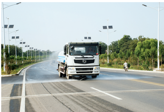
洒水降尘作业中
