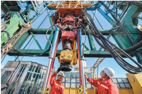
工作人员在钻井平台检查全液压顶部驱动装置
