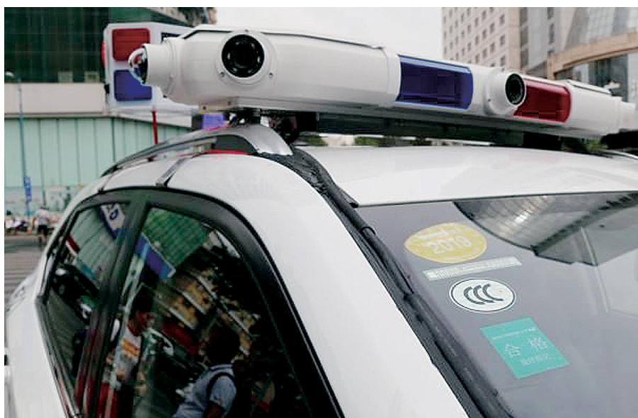
警车顶部的新型抓拍设备有7个高清摄像头
