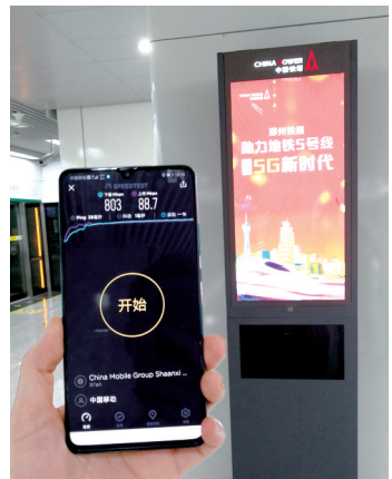
5G网络测速结果显示下载速度达803Mbps
