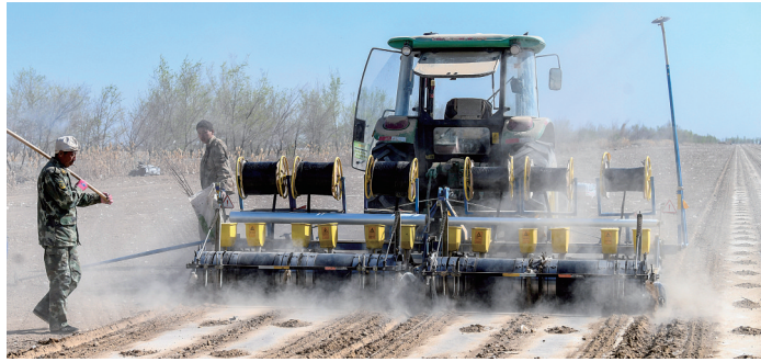
一辆装有北斗导航系统的多功能一体化无人驾驶精准播种机在田间播种 新华社发
