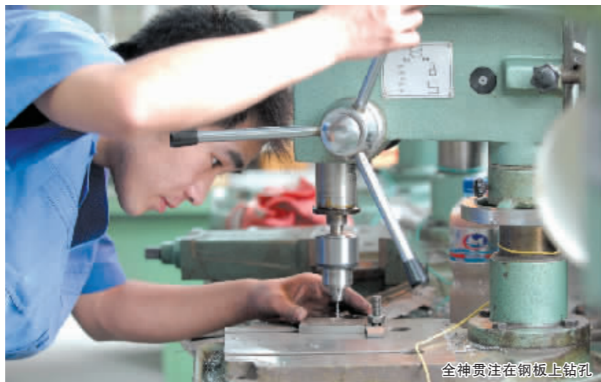
全神贯注在钢板上钻孔
