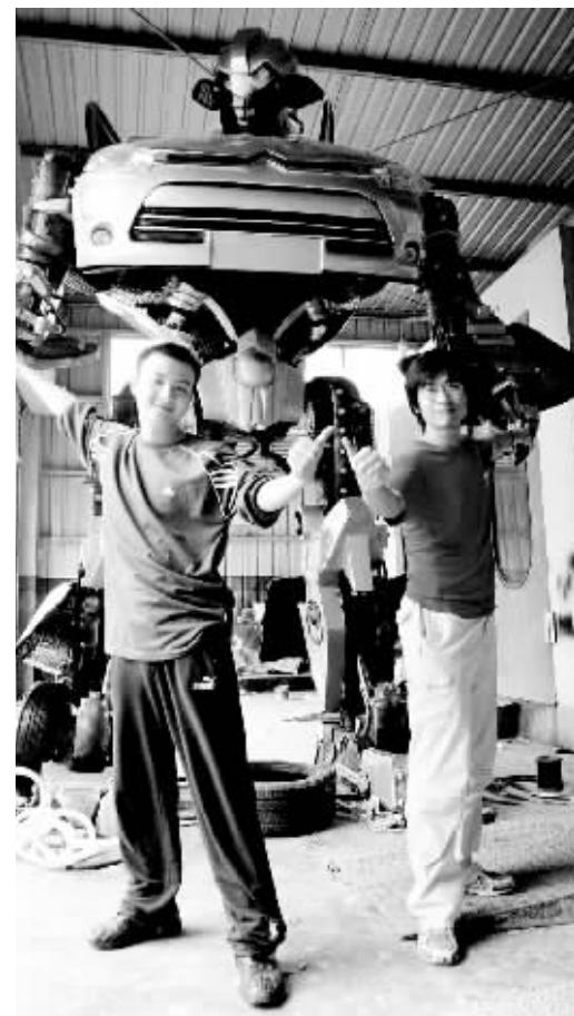
这个变形金刚至少用了四五百个螺帽，50米的杆子，五六百斤的树脂，整个机器人有600多公斤重。
