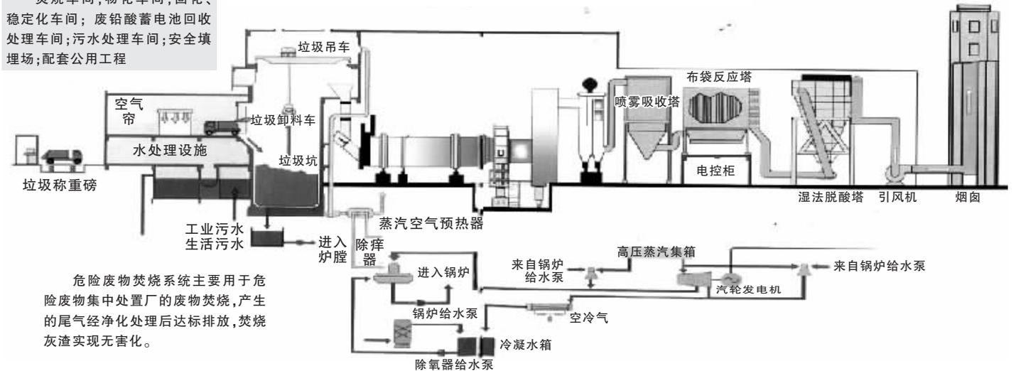
危险废物焚烧系统主要用于危险废物集中处置厂的废物焚烧，产生的尾气经净化处理后达标排放，焚烧灰渣实现无害化。
