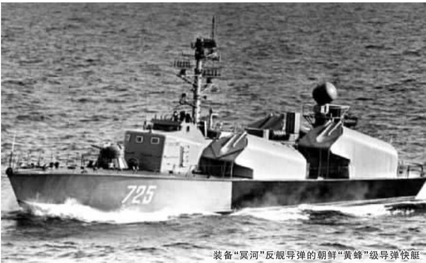
装备“冥河”反舰导弹的朝鲜“黄蜂”级导弹快艇
