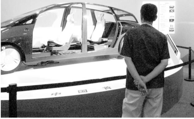
9月2日,人们在吉林省长春国际会展中心东博会E馆观赏一款仅有420公斤重的日本丰田概念车。它是由植物材料建造,比铁更轻更坚固,动力装置比以往小。车内还装配了生物燃料与电能混合动力系统,可使用家用电源充电。 据新华社
