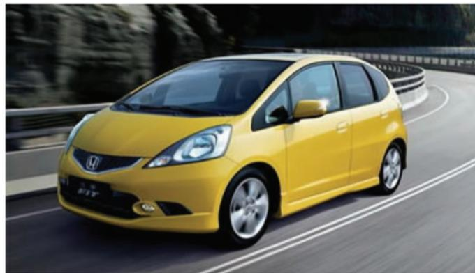
在本田全球首个全方位安全碰撞试验室进行的“车对车”碰撞中,新一代飞度与本田车型中最大、最重的车型LEGEND进行50%偏置碰撞,展示了其高水准的安全性能。继续应用本田精湛的G-CON全方位碰撞安全技术,并首次采用了在第八代雅阁上效果显著的ACE高兼容性车身结构,不仅如此,新飞度从前保险杠,前纵梁,A柱,B柱,侧围,中置油箱框架等车身部件中都采用了高强度钢板作为结构加强,强度较上一代车型提高了164%,这为新飞度获得日本J-NCAP六星级安全评价和“美国高速公路安全局”驾驶员五星成绩提供了保障。同时,四轮碟刹系统,这些都是行驶安全的可靠保证。
