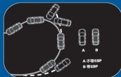
ESP 车身稳定系统 依据车辆行驶状况自动调整驱动力和制动力,确保行车稳定性
