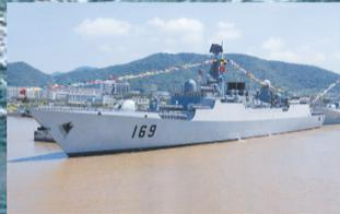
武汉舰是052B型导弹驱逐舰二号舰,2004年服役。全长164米,宽17.2米,长宽比9.5,满载排水量7500吨以上,是一种防空、反潜、反舰能力均衡的远洋驱逐舰。整体性能在国际同级舰中处于中上水平,在亚洲处于先进水平,是中国最新一代的通用型导弹驱逐舰。
