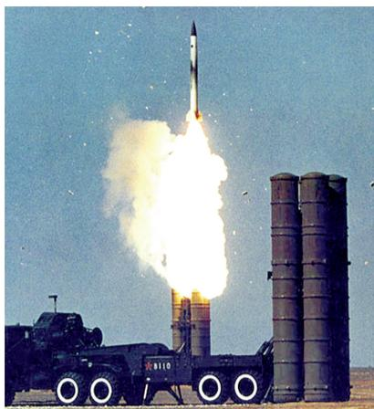
S-300防空导弹系统是目前俄军最先进的防空导弹系统之一，具有拦截空气动力目标、巡航导弹和战术弹道导弹的能力，能同时发射12枚导弹打击6个目标，其最新改进型号的最大拦截距离达到120公里。
