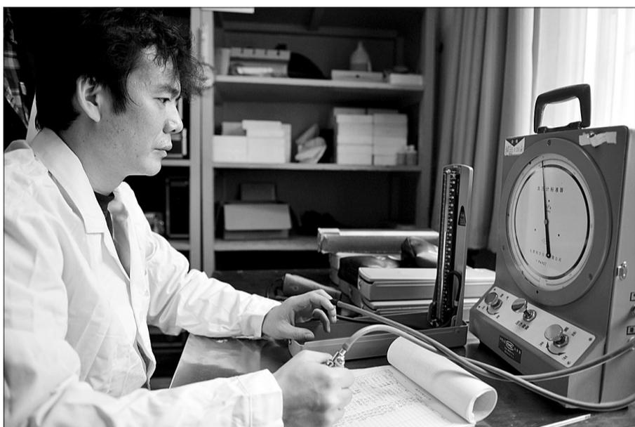
工作人员正在检测维修血压计。
