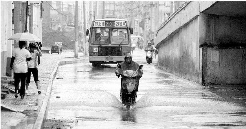
昨日郑州下起小雨,在郑上路与西环路交叉口北侧机动车道,路面的大坑里积满了水。据了解,这一段路原本路况就不太好,但通行没有问题,13日由于某施工单位在郑上路做顶管施工时,将城市供水主管道顶破。经过大水的冲刷和浸泡,再加上小雨不停,这段路上出现了大大小小的水坑。 晚报记者 张翼飞 文/图
