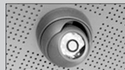
摄像头:车内共有8个,显示车厢内情况有3个,3个门各一个,车后一个,挡风玻璃右上方一个。车长通过监视屏幕可以详细知道车内情况。
