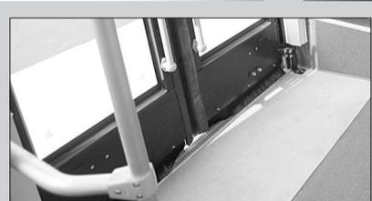
无障碍通道:在门口有个黄色踏板,当有坐轮椅的残疾人上车时,车长或其他乘客可打开踏板,把轮椅推上车,无须搬动。
