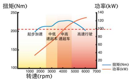
睿翼配备的高科技实用性发动机,在 1600~4000r/min 的中低转速域发挥出最大扭矩 90% 以上的动力输出,0-100km/h 加速仅需 9.5 秒,强悍动力瞬间释放。
