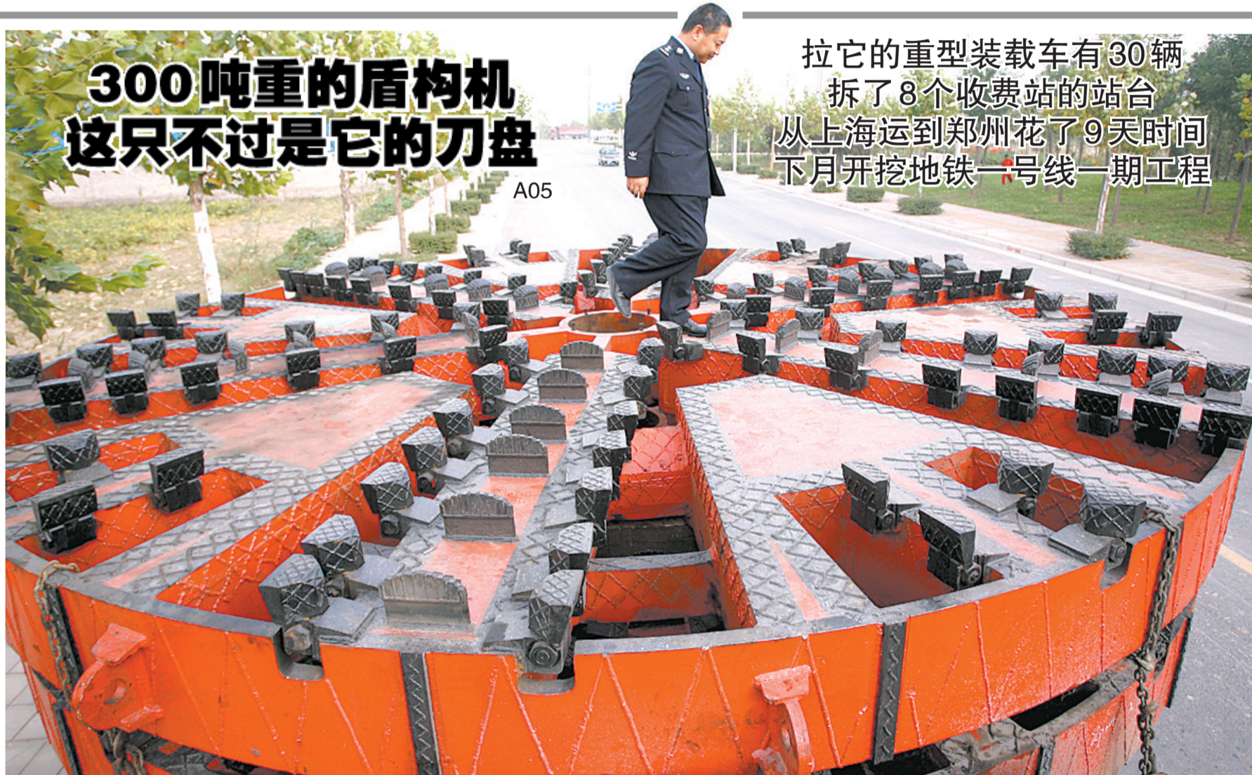
18日,一位负责盾构机交通运输的警察站在巨大的刀盘上看个究竟。“郑州一号”、“郑州二号”盾构机的盾体分刀盘、支撑环和盾尾环,盾构机全长60米。 晚报首席记者 贾俊生 图
