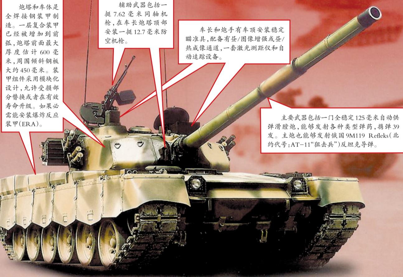
炮塔和车体是全焊接钢装甲制造。一层复合装甲已经被增加到前弧，炮塔前面最大厚度估计600毫米，周围倾斜钢板大约450毫米。装甲组件采用模块化设计，允许受损部分替换或者在有效寿命升级。如果必需能安装爆炸反应装甲(ERA)。
