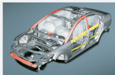
激光焊接高强度吸能式车身+前座四安全气囊+侧安全气囊
