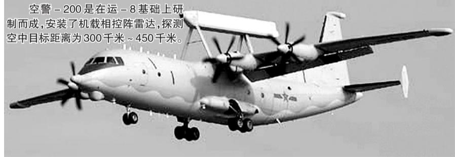
空警-200是在运-8基础上研制而成,安装了机载相控阵雷达,探测空中目标距离为300千米~450千米。
