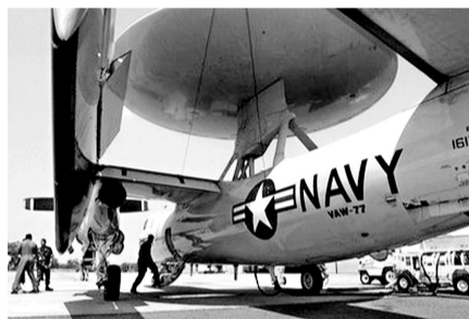
E-2C型“鹰眼”预警机为双引擎涡轮螺旋桨机，最多可搭载5人，所配雷达直径大约7.3米，用于空中指挥、预警、地面侦察、作战协调、搜救行动等。一家美国海军网站提供的数据显示，这种预警机单价大约8000万美元。
