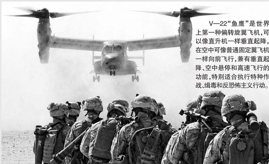
V-22“鱼鹰”是世界上第一种偏转旋翼飞机,可以像直升机一样垂直起降,在空中可像普通固定翼飞机一样向前飞行,兼有垂直起降、空中悬停和高速飞行的功能,特别适合执行特种作战、缉毒和反恐恐怖主义行动。
