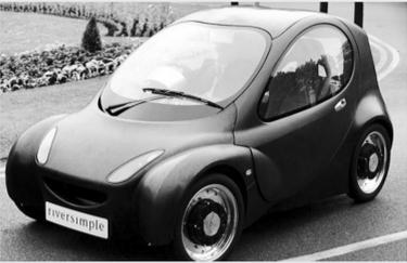
这是一款氢燃料汽车,每加仑燃料可行驶300英里(482公里),排出的是水而不是烟。这款无污染的两座汽车用氢发电驱动电动机。最高时速为50英里(80公里),一箱液体氢可行驶240英里(386公里)。
