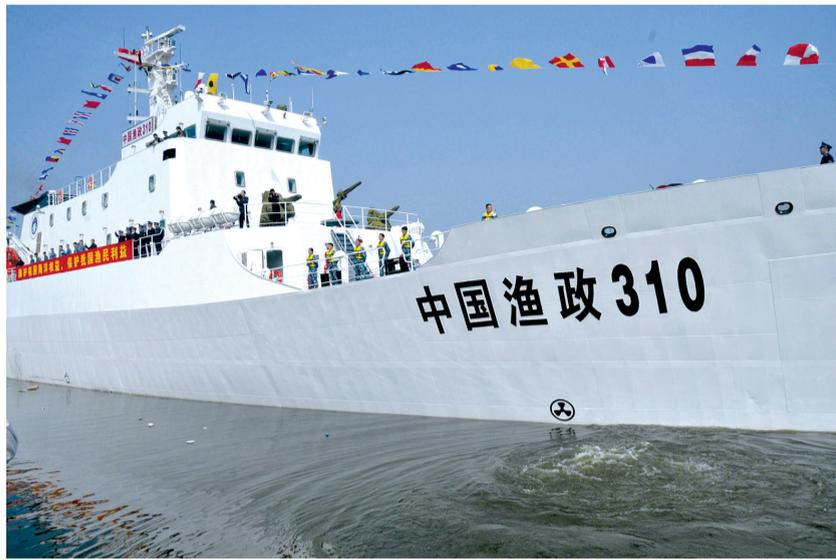
16日11时,我国第一艘配载直升机的渔政执法船——中国渔政310船,驶离广州的中国渔政码头,开赴东海某海域执法。这标志着我国渔政执法已从单一海上执法走向海空结合的立体执法时代。中国渔政310船总吨位为2580吨,可配置两架船载Z-9A型直升机,可续航60个昼夜、抗12级风浪、最大航速可达每小时22海里。该船已成为目前我国渔政系统船舶中航速最快、总体性能最先进、特种设备配备最齐全渔政船。
