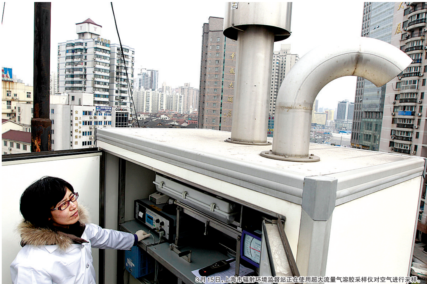
3月15日,上海市辐射环境监督站正在使用超大流量气溶胶采样仪对空气进行采样。
