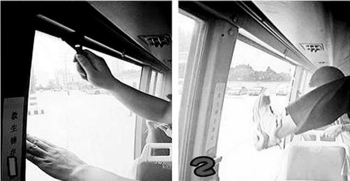
动车组车窗大多使用钢化玻璃。这种玻璃的特点是“中心硬,四角脆”,所以用脚猛踹或用硬物击打玻璃的中心部位时,往往只会使玻璃龟裂、张力增强,反而更不容易破碎。
