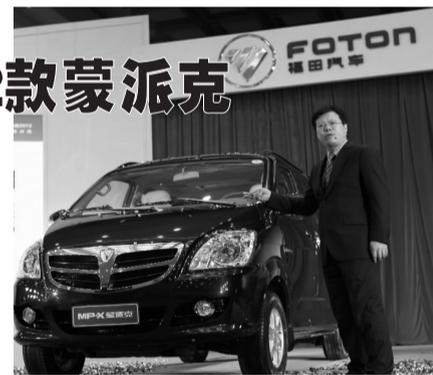
(Noise、Vibration、Harshness),是行业衡量汽车制造质量的一个综合性问题。有统计资料显示,整车约有1/3的故障问题是和车辆的NVH问题有关系。2012款蒙派克通过发动机匹配双质量飞轮、水箱悬置改进、进排气噪声改进、增加扭转减震器四项措施,全面提升了2012款蒙派克的NVH性能。如果说NVH系统升级让2012款蒙派克为用户提供了静宜空间,那么内饰的优化则为用户带来高品质视觉和触觉享受:2012款蒙派克座椅根据人机工程学原理全新造型,根据乘坐空间优化了座椅尺寸;其次,2012款蒙派克还匹配全新环保材质地铺,减少了车内异味,使整车舒适性得到明显优化。
