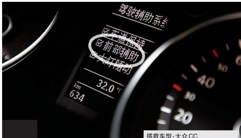
搭载车型:大众CC 系统设备:毫米波雷达 作用范围:30km/h以下避免碰撞 预警对象:车辆
