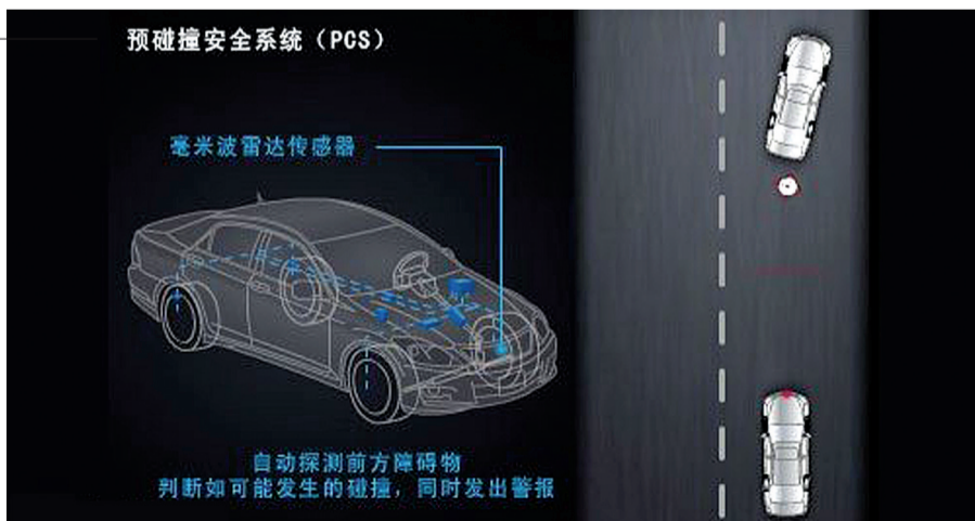
搭载车型:皇冠、雷克萨斯GS460, LS460L、LS600hL和RX350等 系统设备:毫米波雷达、摄像头 作用范围:速度未知,但不能刹车至完全停止 预警对象:车辆、行人
