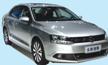
新迈腾:该车采用了大众最先进的技术,包括TSI直喷涡轮增压发动机,TIPTRONIC自动变速箱,以及后期的DSG双离合自动变速箱,HSB高强度结构车身,42米长的激光焊接等。
