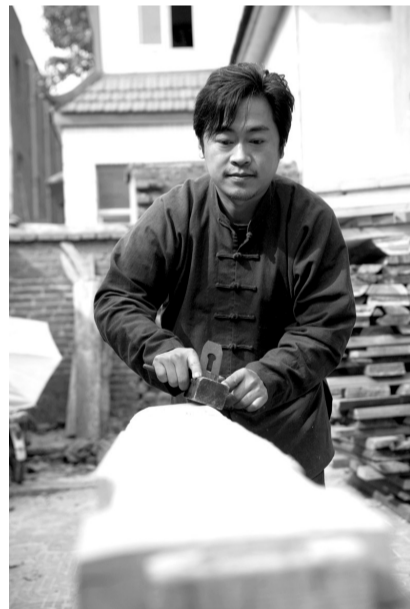
对选择好的制作古琴的木材进行粗加工，削去多余材料。
