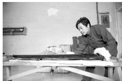
每天涂一层大漆，然后擦去，保留极少一层，干了后继续。反复无数遍，直到琴的色彩达到满意度。
