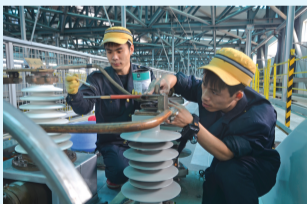
技术人员正在对列车车顶绝缘瓷瓶喷涂防污闪涂料
