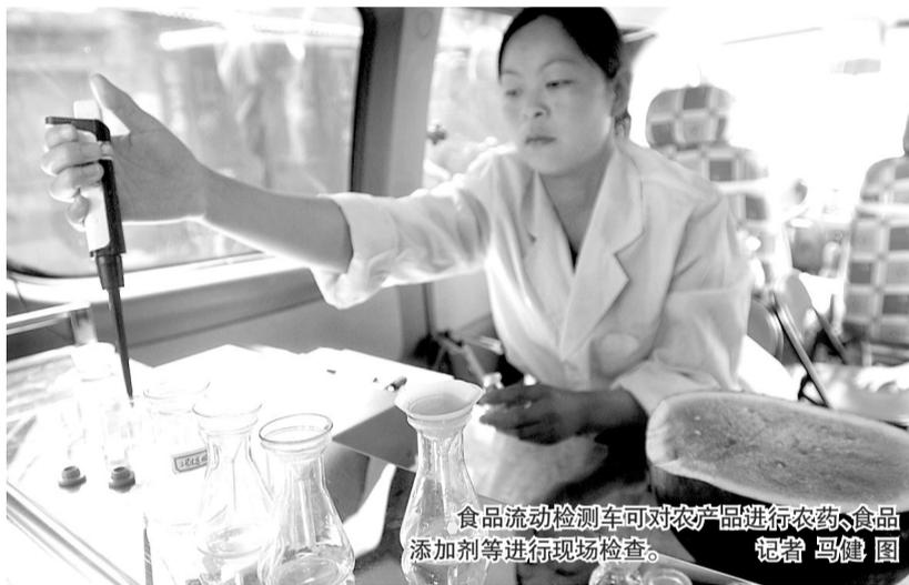
食品流动检测车可对农产品进行农药、食品添加剂等进行现场检查。 记者 马健图
