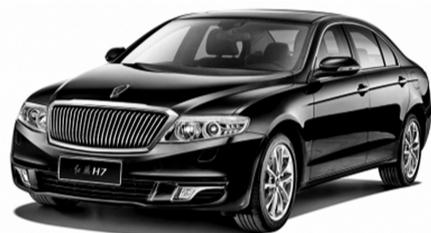
5月30日,中国第一汽车集团公司在国家体育馆鸟巢隆重举行以“让理想飞扬”为主题的红旗H7上市发布会。红旗H7用“四大科技”保障其整体构建设计理念得以落实。首先是“全领域智能管理”。全车采用先进的CAN网络下的电子电气平台技术,控制模块多达36个,在同级别车型中处于领先地位。在此基础上,博世第九代车身电子稳定系统ESP、ACC自适应巡航控制系统、道路偏航预警、前防撞预警、人性化的智能前照灯、4.2英寸TFT液晶显示屏、8英寸LCD触摸屏等科技装备,凸显了红旗H7的智能科技。红旗H7搭载自主研发的3.0L和2.0T两种排量的发动机,匹配6速手自一体变速箱,拥有收放自如的澎湃动力;高性能的底盘悬架系统铸就了红旗H7随心所欲的卓越操控;主动夜视系统ANV、大灯随动转向系统AFS、AUTO HOLD自动驻车功能、第九代ESP系统的运用,使得红旗H7从容应对各种复杂路况。
