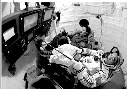
4月14日,航天员聂海胜、张晓光(右)在模拟返回舱内进行手控交会对接训练。
