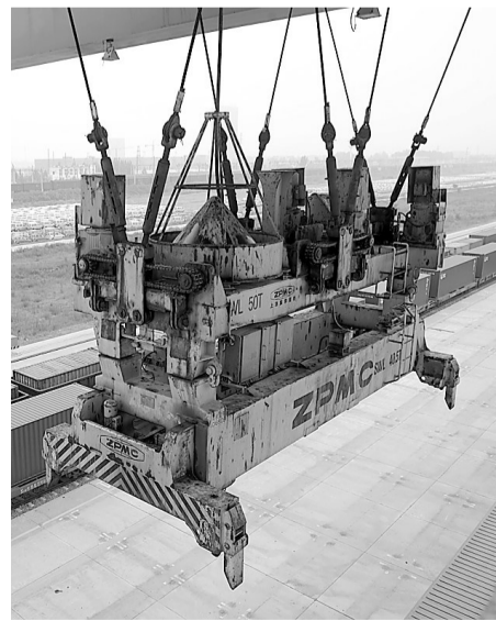
郑州铁路集装箱中心站,准备运往欧洲的集装箱整装待发。这是运送集装箱的抓手。 郑州晚报记者 张翼飞 图
