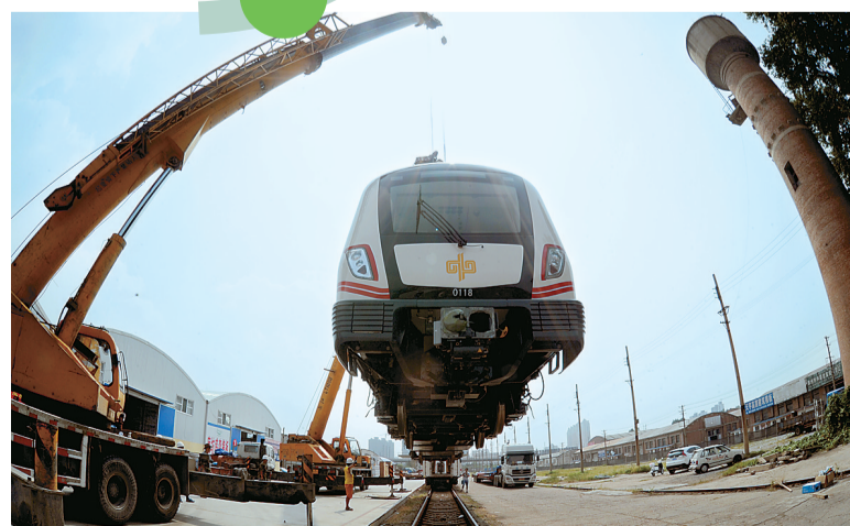
吊车正在将车顶吊上拖车。
