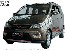
菱宏光S搭载了通用最新一代1.5L、1.2L P-TEC 发动机,具有低转速高扭矩的特点,且燃油经济性极高。1.5L发动机的最大功率可达82kw,最大扭矩为146.5牛米/3600~4200转,油耗仅为7.5L/百公里。
