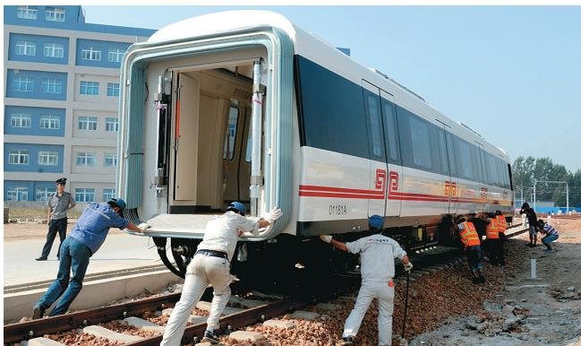
▲由于车体大量使用铝合金材料,车厢重量较老式的地铁车型大大减少,因此一节车厢四五个普通人就可以轻松推动,从这方面也可以看出郑州的地铁将会多么的节能环保。
