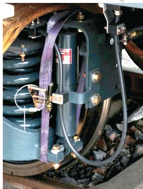
◀在列车被吊离地面之前,技术人员用专用的尼龙带将减震弹簧的上下部进行紧固,防止在吊装过程时减震弹簧移位,影响车轮的性能。
