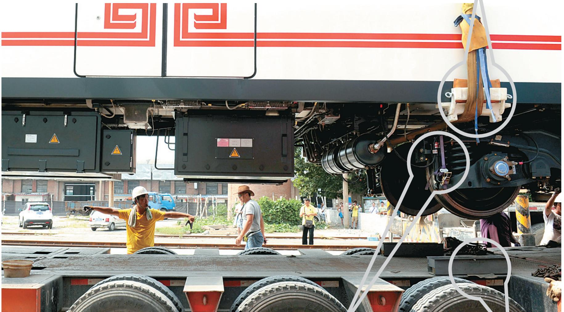
▲工作人员指挥着吊车司机将列车的车轮停放在半米长、两头封闭的“铁轨”上。
