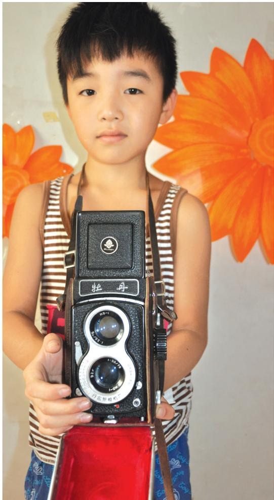
海鸥4B是120双反相机里最大众化和最普及的产品,其构造简单,价格便宜,操作方便,生产于1976年~1979年间。海鸥4B相机快门速度:B,1-1/300秒,带自拍器,手轮、卷片,红窗计数。光圈:3.5,4,5.6,8,11,16,22。这台相机带原包装牛皮套,各部件齐全,仍可正常使用。
