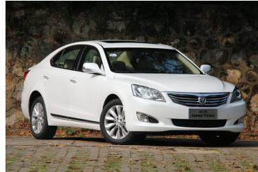
长安睿骋以商务大气元素为设计思路,包括镀铬格栅、雾灯、轮毂造型以及前后包围在内的细节设计。睿骋为长安汽车位于意大利都灵的研发中心设计开发,其长宽高分别为4920/1825/1500mm,轴距2800mm,全车尺寸处在主流中高级轿车的较高水平。动力方面,长安睿骋装备全新开发代号D18T的1.8L涡轮增压发动机,配备日本爱信6速手自一体自动变速器,后续将装配新款2.0L发动机。
